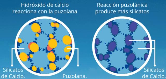
La puzolana que contiene el cemento MULTI-PROPÓSITO YURA IP, reacciona con el hidróxido de calcio, produciendo más silicatos de calcio, lo que otorga mayor resistencia, sellando los poros haciendo un hormigón más impermeable.
